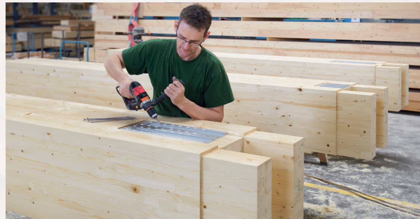
Abbund bei Wiehag in Alheim: Rund 6000 m 3 Brettschichtholz für 1900 Stützen und 1660 Träger inklusive vormontierter Verbindungsmittel gelangten nach Singapur.
