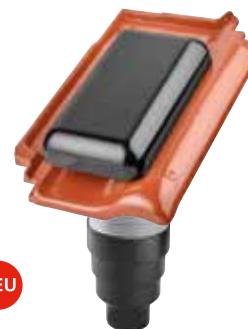
ALU-SYSTEM Sanitär-PV-Flachlüfter DN 125 mit flacher schwarzer Haube 1) zum Einbau oder Austausch unter Solaranlagen, Anschlusschlauch (70 cm), UD-Manschette und Reduzierstück
