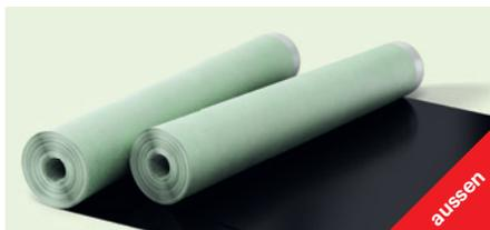
Zweilagige, schwer entflammable schwarze Winddichtung für Fassaden mit offenen Fugen, bestehend aus einem PET-Vlies mit TPU-Beschichtung. Nach EN 13859-2 für Wände mit offenen Fugen wurde die künstliche Alterung mit 5000 Stunden UV-Belastung durchgeführt (Standard sind 336 Stunden). **Das Vlies besteht zu 100% aus recyklierten PET-Flaschen**.
