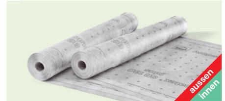
Zweilagige Dampfbremse, Luftdichtung und Schalungsbahn aus thermisch verfestigten Endlosfasern mit PP-Füllschicht (100% Polypropylen). Freibewitterbar. Ideal für Aufsparrendämmung. **100% recyklierbar**.
