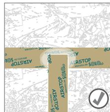
AIRSTOP SOLO Klebeband unter dem losen Ende mit beiliegendem Schleifpad anrauen. Schleifstaub wegwischen. Auf dem „matten“ Untergrund das Band mit Anpressdruck anbringen.
