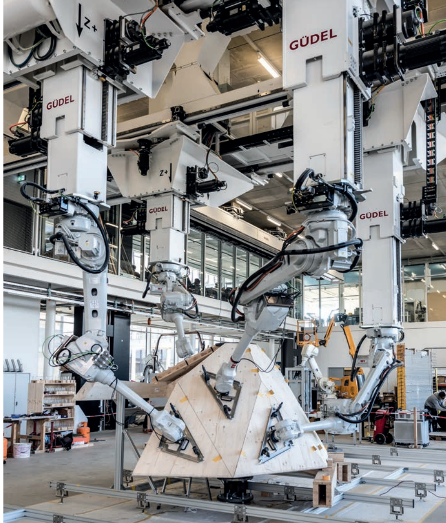
Die Platten sind mittels einer neuartiger Fugenabdichtungstechnologie verbunden: Das Verfahren ermöglicht eine starre Verbindung von größeren Holzplattenkanten
