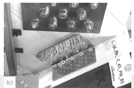
Abbildung 2: Probekörper nach Durchführung der Zugversuche (a), Schubversuche (b) und 45° zyklischer Last (c) (jeweils mit Teilausnagelung).
