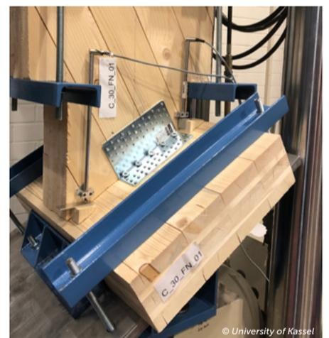
Abbildung 1: 30° Versuchsaufbau für 60° Lasten.
