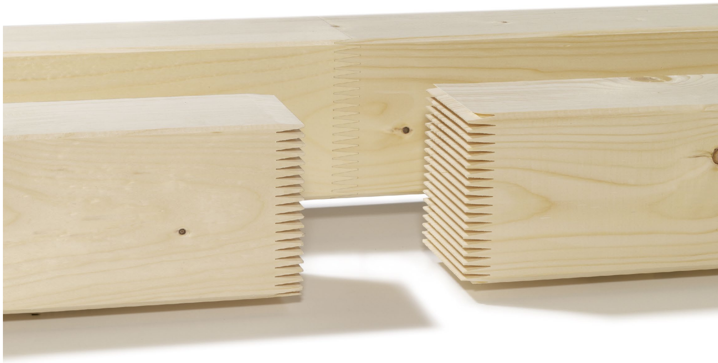
11 | Der Klebstoff von Keilzinkenverbindungen wird aufgrund seiner hellen Farbe kaum wahrgenommen.
