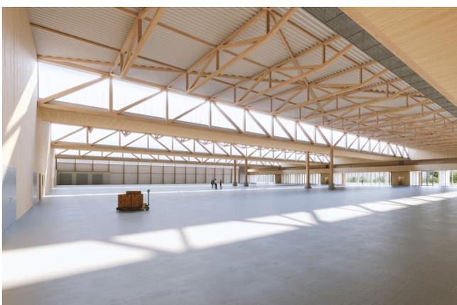
Rund 82 m lange Fachwerkträger mit nur einer Stütze überspannen als Zweifeldträger die Halle. BauBuche ermöglicht es, die Feldweiten von 40 m bzw. 42 m mit filigranen Träger-Abmessungen zu überbrücken. (Visualisierung: HK Architekten)
