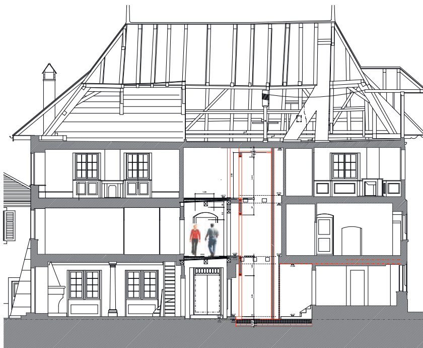
Der Lifteinbau stellte einen grösseren Eingriff in die Bausubstanz dar. Aufgrund des Brandschutzes ist der Lift in sich selber abgekoppelt und entsprechend den Anforderungen EI 30 ausgeführt.
