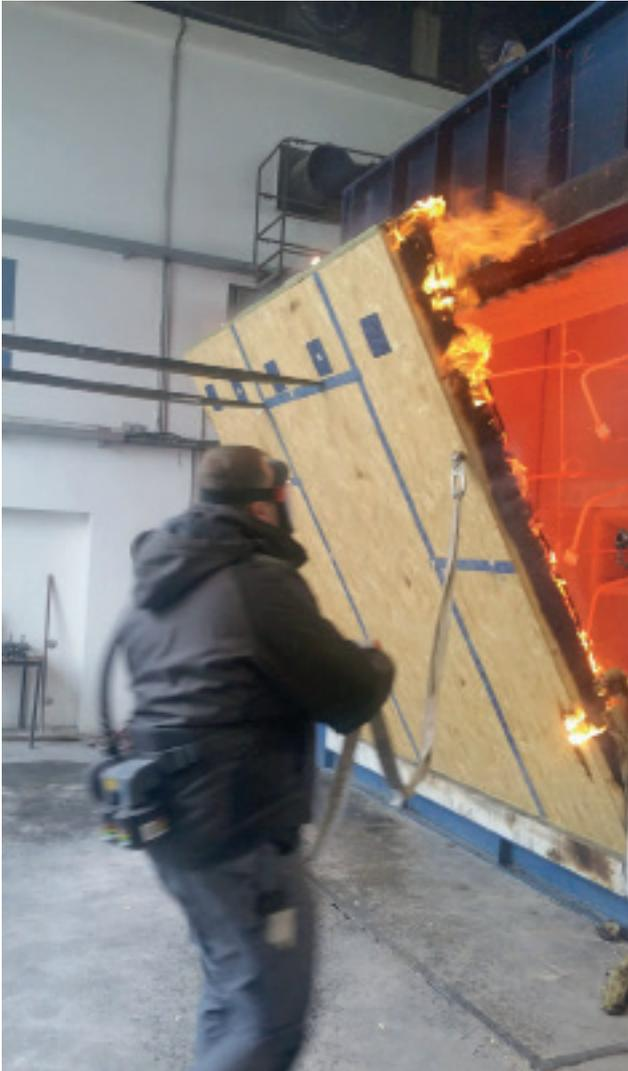
Hält dem Feuer auch unverputzt mindestens 60 Minuten stand: Eine Holzständerwand mit der Dämmplatte best wood WALL / Top 180 und der Holzfaser-Einblasdämmung best wood FIBRE beim Test in der MFPA Leipzig.
