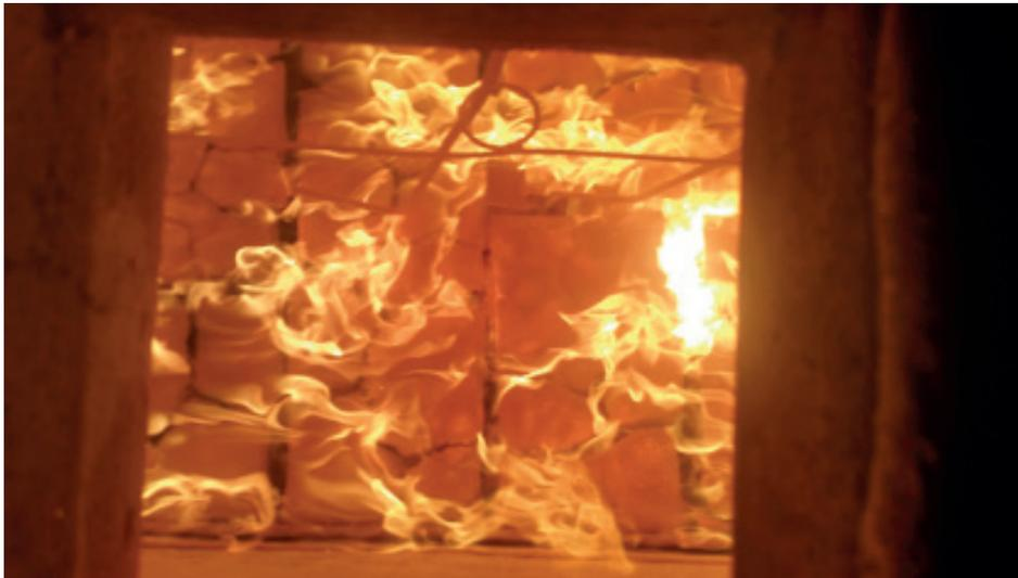
**Obwohl nur 235 mm stark, widersteht ein Bauteil aus den Holzfaserdämmstoffplatten best wood WALL 180 / TOP 180, der Einblasdämmung best wood FIBRE und einer OSB-Platte mindestens 60 Minuten lang dem Feuer.**
