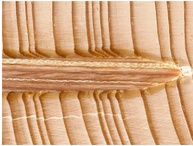
Bild 2: BECK LignoLoc® verbindet sich stoffschlüssig mit dem Umgebungsholz. Quelle: BECK Fastener Group
