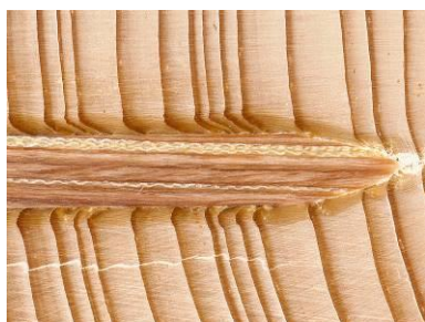
Bild 3: BECK LignoLoc® verbindet sich stoffschlüssig mit dem Umgebungsholz. Quelle: BECK Fastener Group
