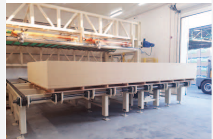
Abstapelung der neuen XXL-Platten
