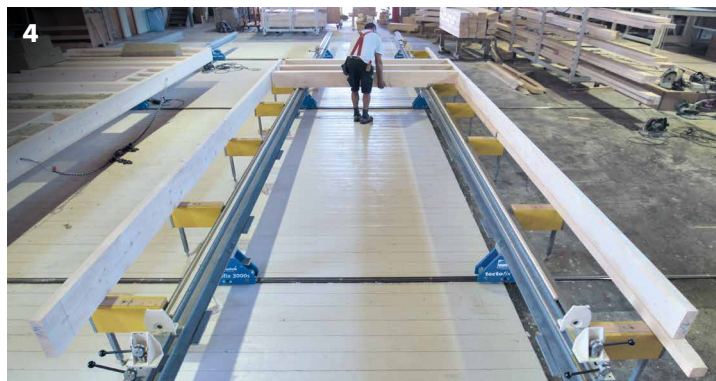
4 + 5 / Wandfertigung in idealer Arbeitshöhe: Auch beim Einlegen schwerer Ständer ergonomisch perfekt, da der „Tisch begehbar“ ist
