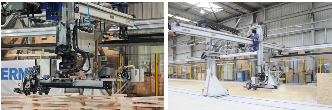
Der preisgekrönte Portalroboter von ERNE AG Holzbau im Einsatz (Foto: ERNE AG Holzbau)
