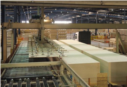
Aufstapelung der SWISS KRONO OSB Longboards mittels Saug-Traverse und Transport der SWISS KRONO OSB Longboards in die Schweiz. (Fotos: SWISS KRONO GmbH)
