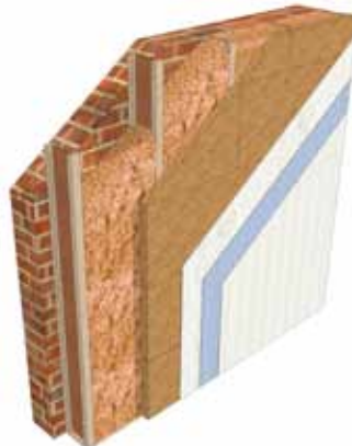
WDVS auf mineralischem Untergründen mit Holzrahmenkonstruktion
